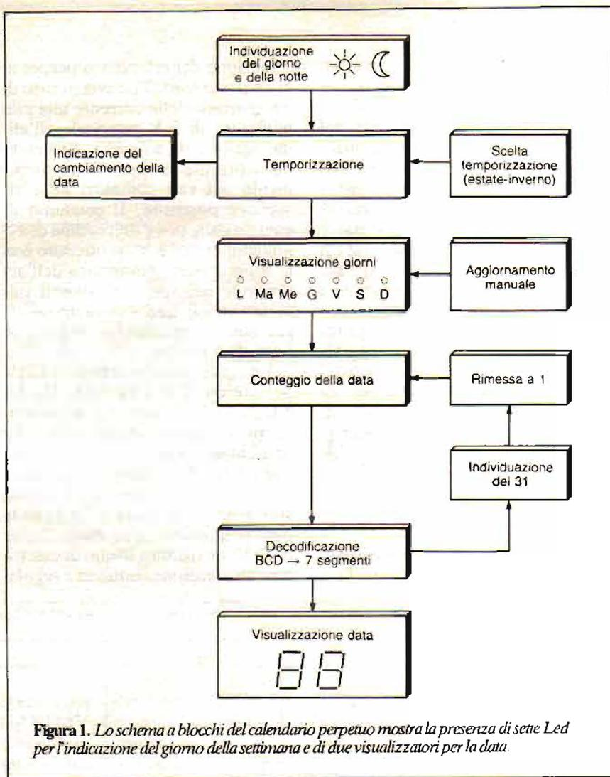
Figura 1. Lo schema a blocchi del calendario perpetuo mostra la presenza di sette Led per l'indicazione del giorno della settimana e di due visualizzatori per la data.
