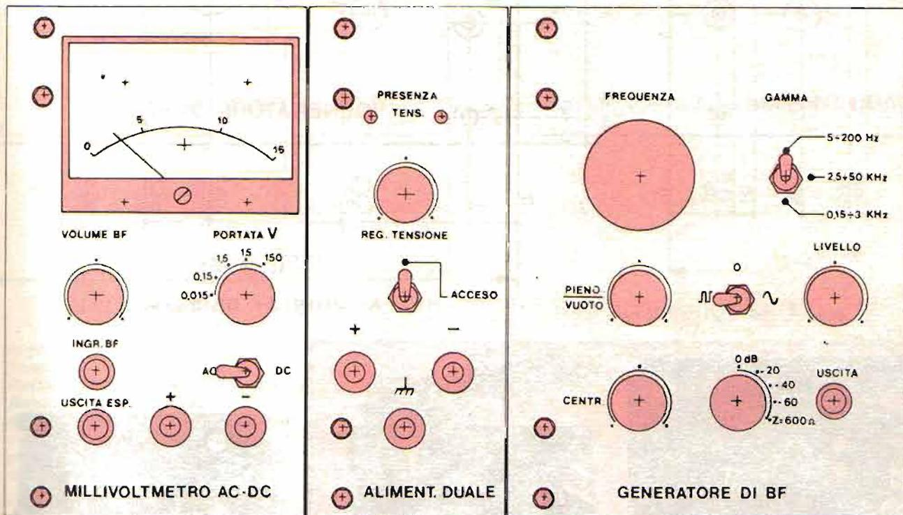
*In alto il cestello Rack Peruzzi che abbiamo scelto come contenitore per la serie modulare di strumenti. Qui sopra, come si presenteranno i frontalini degli strumenti, una volta ultimati. Questa disposizione è stata scelta solo a titolo di esempio: gli strumenti possono essere affiancati anche in ordine diverso.*
