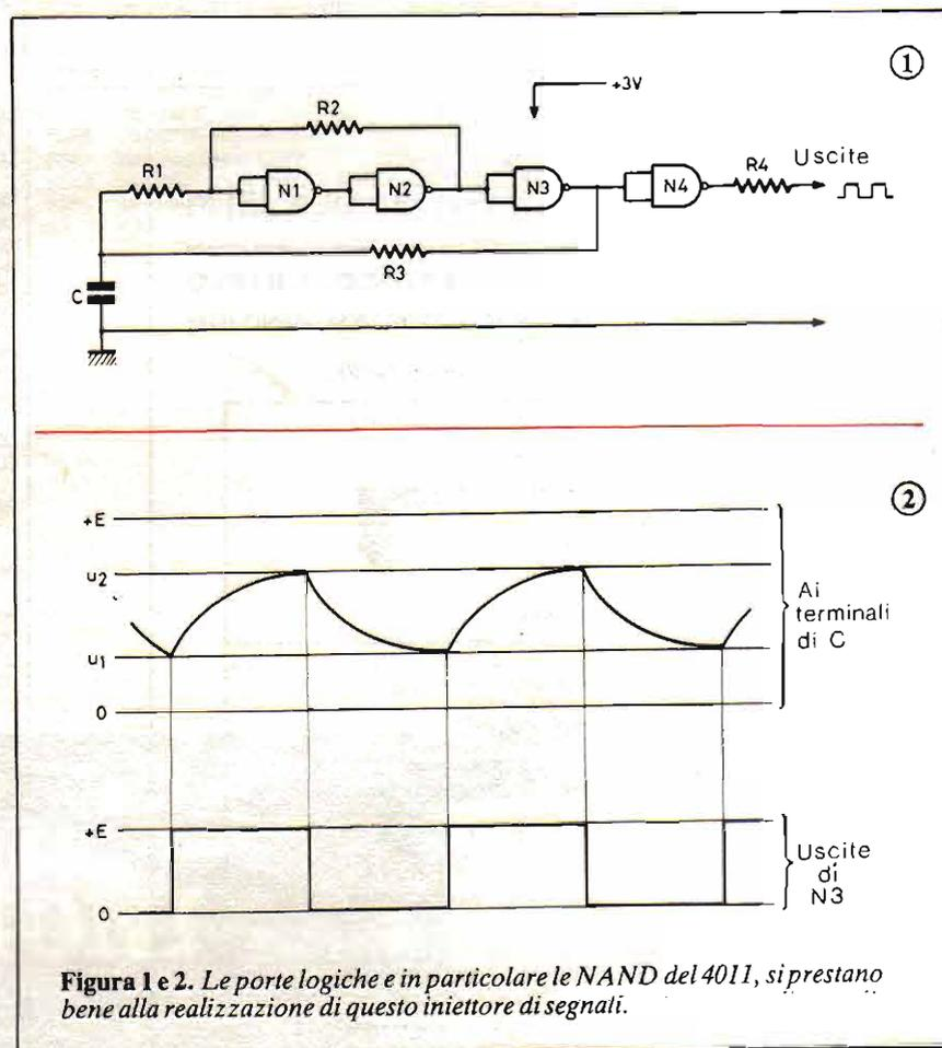
Figura 1 e 2. Le porte logiche e in particolare le NAND del 4011, si prestano bene alla realizzazione di questo iniettore di segnali.
