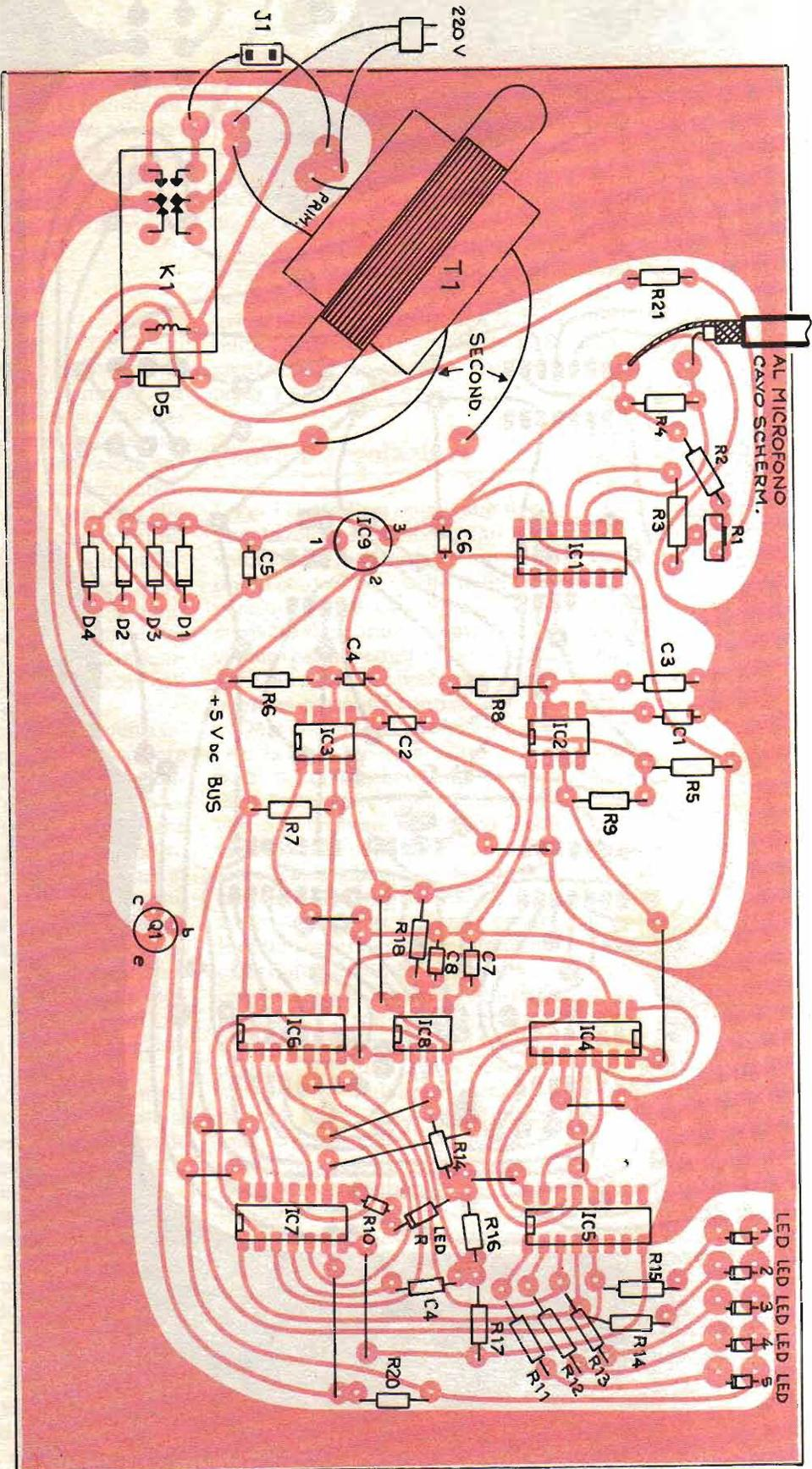
**Figura 4.** Ecco il disegno in grandezza naturale della disposizione dei componenti. Fate attenzione a rispettare la polarità dei diodi e dei Led: i Led hanno sul terminale negativo una tacca che vi aiuterà a distinguere i terminali. Alcune delle piste di rame sono vicine: dopo la realizzazione controllate che non ci siano ponti di stagno.
