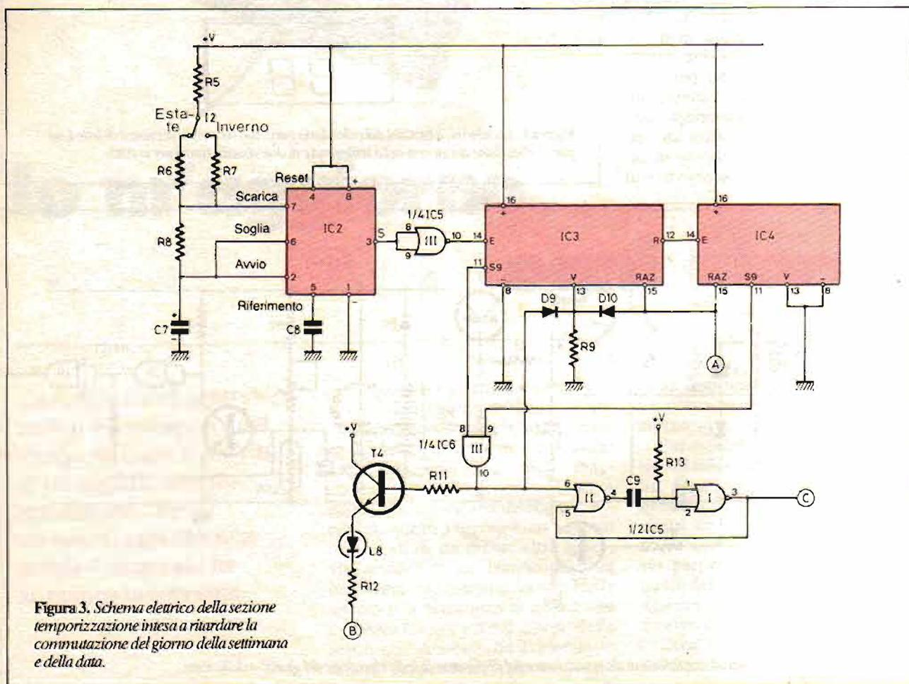
Figura 3. Schema elettrico della sezione temporizzazione intesa a riardare la commutazione del giorno della settimana e della data.
