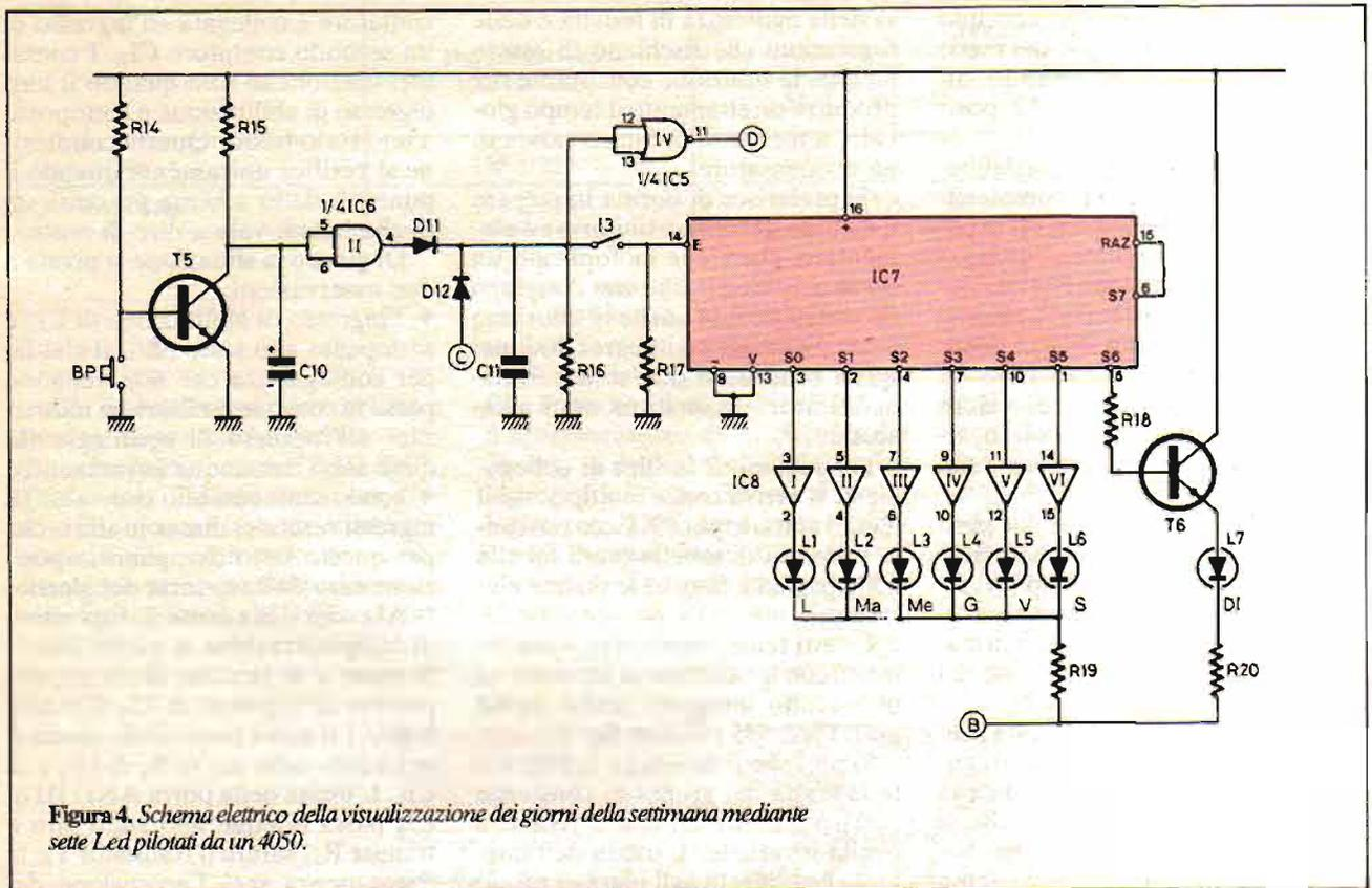
Figura 4. Schema elettrico della visualizzazione dei giorni della settimana mediante sette Led pilotati da un 4050.
