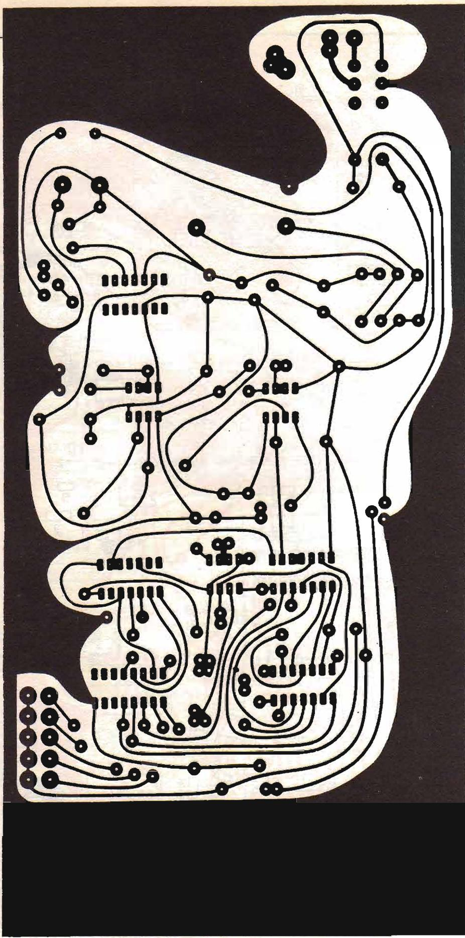
Figura 3. Ecco il tracciato in scala 1:1 del circuito stampato.
